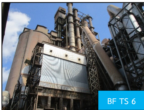
ภาพที่ 2.1 อุปกรณ์ดักฝุ่นแบบถุงกรอง (BF)
