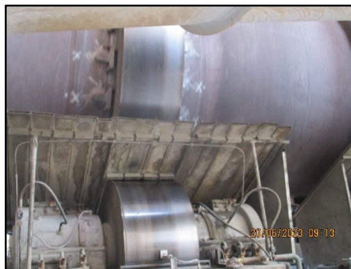
ภาพที่ 2.62 สภาพฉากป้องกันความร้อนระหว่าง Preheater กับคนงานและติดตั้งกรงเหล็ก
